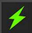
Se enciende al conectar el cargador en el puerto de carga delantero del vehículo. El mismo destellará mientras se encuentre en el proceso de carga y una vez alcanzada la carga completa se quedará iluminada fijamente, indicando que ya el vehículo se encuentra cargado.
