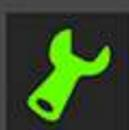
Señal de advertencia. Se enciende cuando existe un problema en el sistema de carga del vehículo, sea que existe una irregularidad en la conexión en el puerto de carga del vehículo o un problema interno del sistema de carga del vehículo, a lo que deberá dirigirse a un centro de servicio autorizado.
