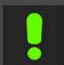
Señal de advertencia. Se enciende cuando existe un problema en el sistema de carga, en lo que respecta al cargador, sea que existe una irregularidad en la acometida (bajo voltaje, una fase inexistente u otra condición en la acometida), o un problema interno del cargador, que se encuentre dañado.
