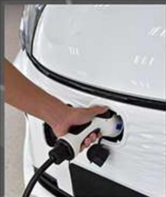
**1** Desconectar el cargador del puerto (slot) de carga lenta del vehículo ubicado en la parte delantera del vehículo.
