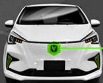
**3** Cerrar la compuerta que sirve como protección contra polvo y humedad al puerto (slot) de carga lenta del vehículo.
