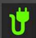
Se enciende al conectar el cargador al tomacorriente que se encuentra en la pared, es decir, a la acometida que se ha dispuesto para cargar el vehículo. Se enciende en tono verde, y la misma indica que el cargador se enchufó al tomacorriente y conectado a la red o acometida de alimentación.
